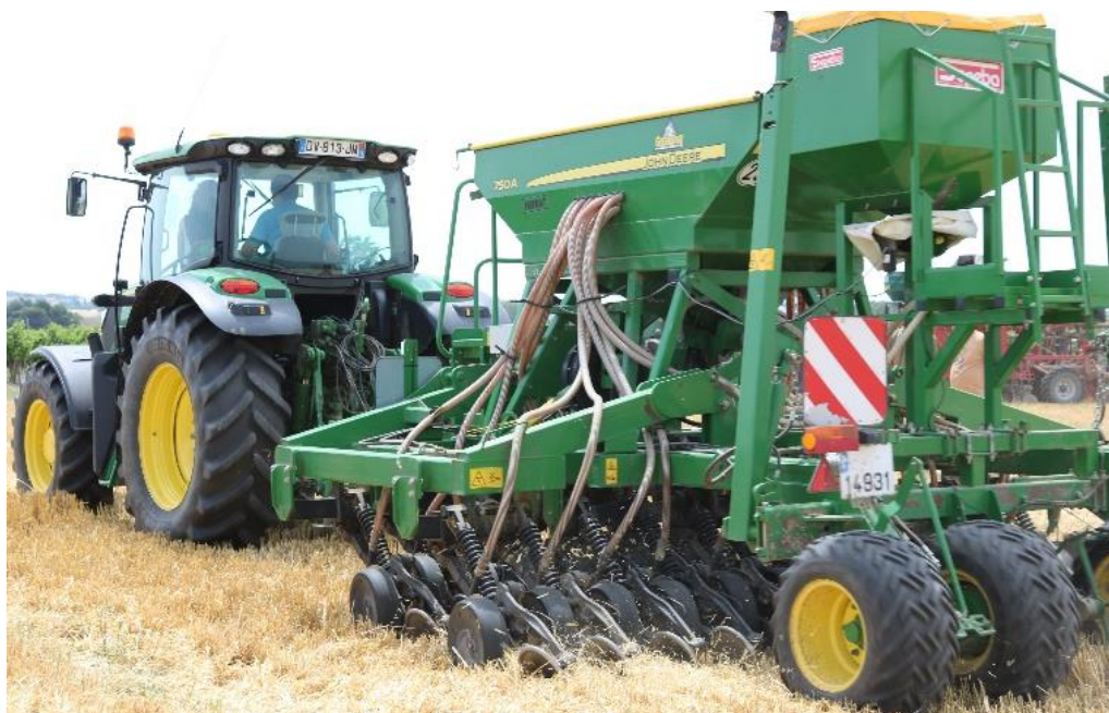
Photo 3 : Semoir direct John deere, disques droits, écartement de 16cm
