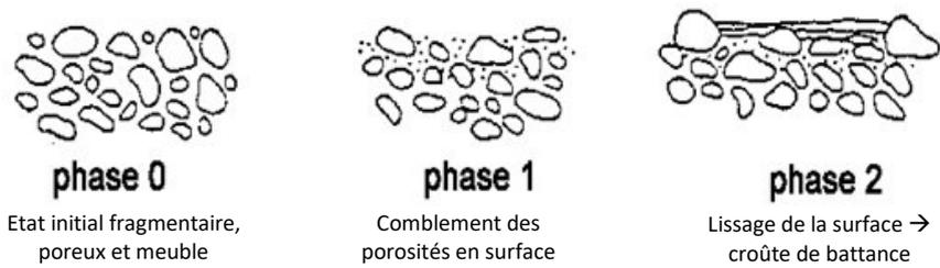
Figure 19 : Développement d'une croûte de battance à la surface du sol sous l'effet splash des gouttes d'eau (Source : Cosandey, 1990)
