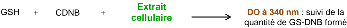
Figure 17 - Principe du dosage de l'activité de la glutathion S-transférase (GST). GSH : glutathion réduit ; CDNB : 1-chloro-2,4-dinitrobenzène ; GS-DNB : complexe coloré formé entre le CDNB et le GSH
