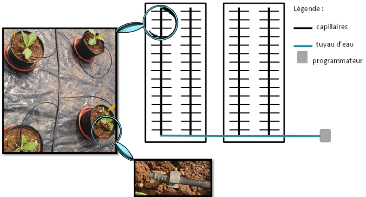
Figure 16 : Schéma du système d'irrigation à la serre (photos personnelles)
