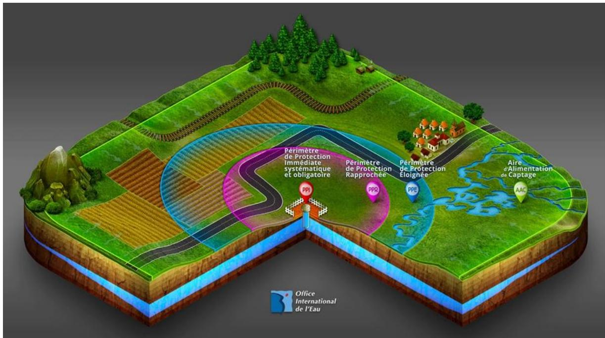
Figure 8 : Schématisation des périmètres de protection de captage d'eau potable (Barreau et al., 2020)
