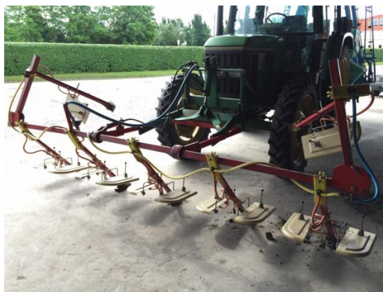
Figure 4 : Rampe de traitement "en dirigé"
