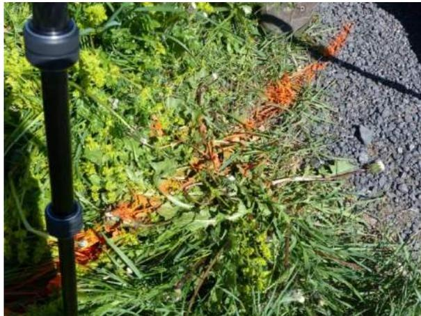
2. Placer le trépied : la colonne du trépied doit être sur le point trouvé précédemment
