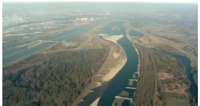
Figure 5 : Grand Canal d'Alsace (à gauche), ses barrages et le Vieux Rhin et ses épis (Source : [http://wikhydro.developpement-durable.gouv.fr/index.php/Canalisation\\_du\\_Rhin](http://wikhydro.developpement-durable.gouv.fr/index.php/Canalisation_du_Rhin))
