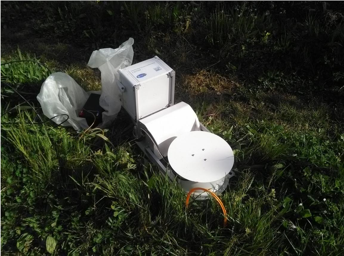
*Figure 8: Analyseur C-flux en cours de mesure. La chambre de mesure (partie ronde) est abaissée*
