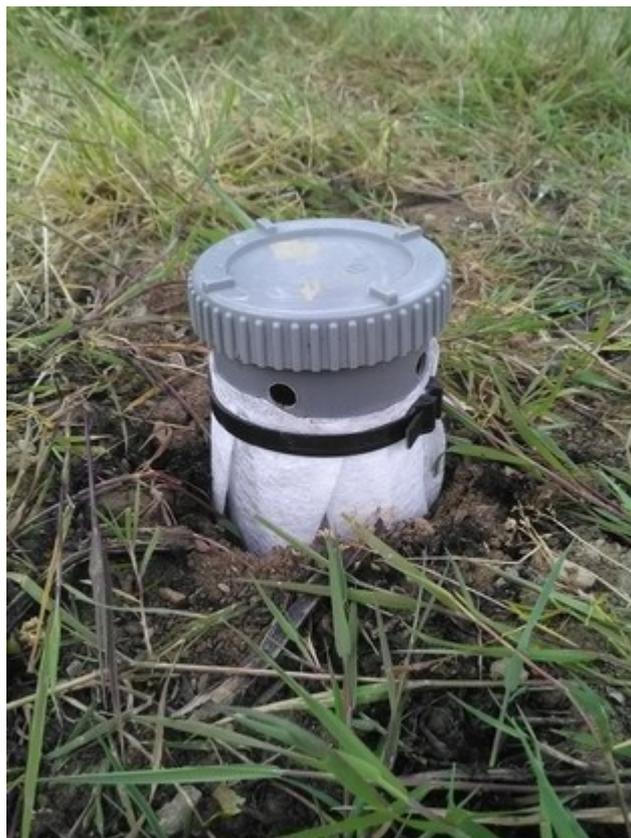
*Figure 9: Tube de mesure de la vitesse de minéralisation de l'azote in situ*
