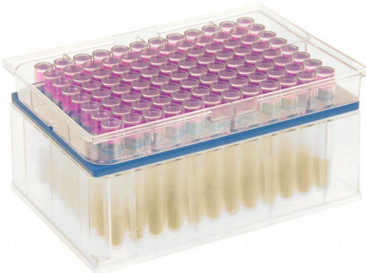
*Figure 7: Kit MicroResp. La gélose colorée se situe dans la plaque du haut, scellée à l'aide d'un joint à la plaque des micro-puits contenant les échantillons de sol et le substrat*
