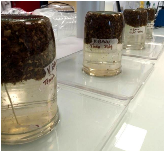
Fig. 10 : Culture d'œufs de strongles en bocaux (à gauche : bocaux retournés depuis quelques minutes ; à droite : bocaux retournés depuis 24h)
