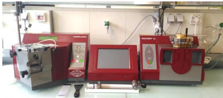
Figure 6 : Alvéographe de Chopin de la marque CHOPIN Technologies™, 2017. L'appareil est équipé d'un pétrin qui permet la formation des pâtons (à gauche), d'un système de mise sous pression et d'un tambour enregistreur (à droite).
