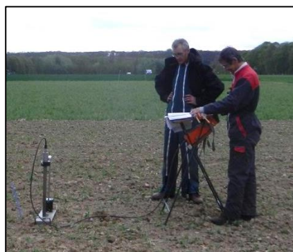
Figure 14 : Mesure des masses volumiques par sonde Gamma pour les profondeurs entre 5 et 40 cm.
