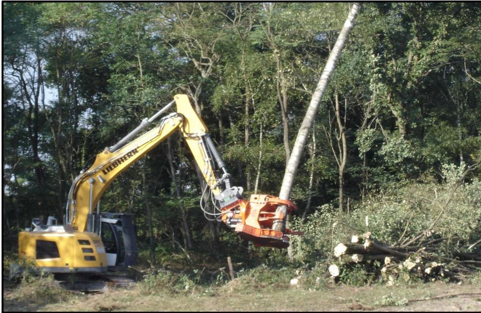
Figure 3 : photo d'un chantier de coupe du bois au grappin-coupeur, CUMA Compost 71
