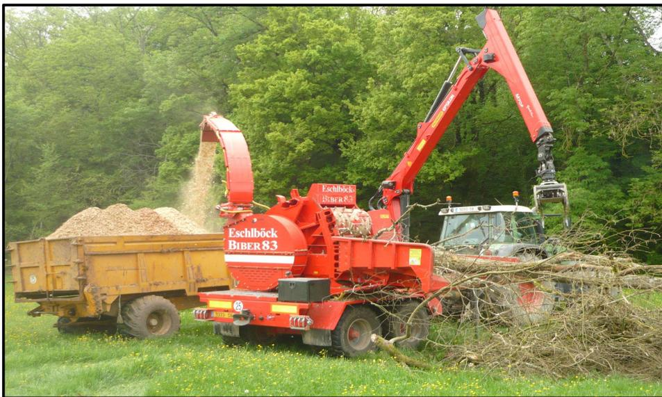
Figure 4 : photo d'un chantier de déchetage du bois pour produire des plaquettes, CUMA Compost 71
