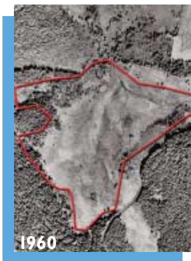
Entre 1960 et 2000, le réseau hydrographique (linéaire foncé sur la photo 1960) a été creusé en fossé de drainage (linéaire blanc sur photo 2000), provoquant l'assèchement de la tourbière.
